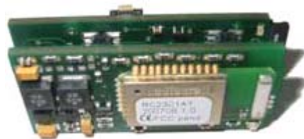
Bild 3 Kontextsensorik mit Zigbee-Interface
